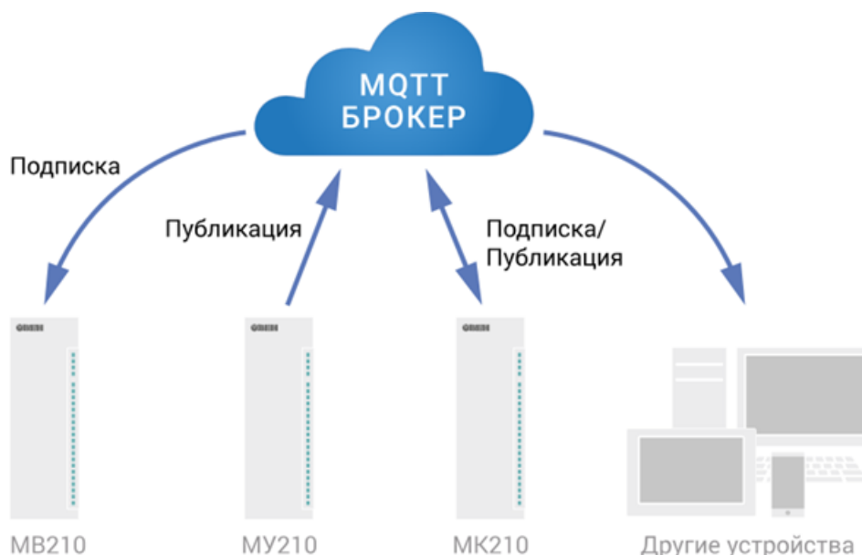
Рисунок 6.2 – Структурная схема обмена по протоколу MQTT
